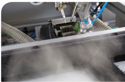
Die integrierte Lötrauchabsaugung schützt 3-fach gegen Schadstoffe, den Anwender, das Werkstück und die Maschine.
