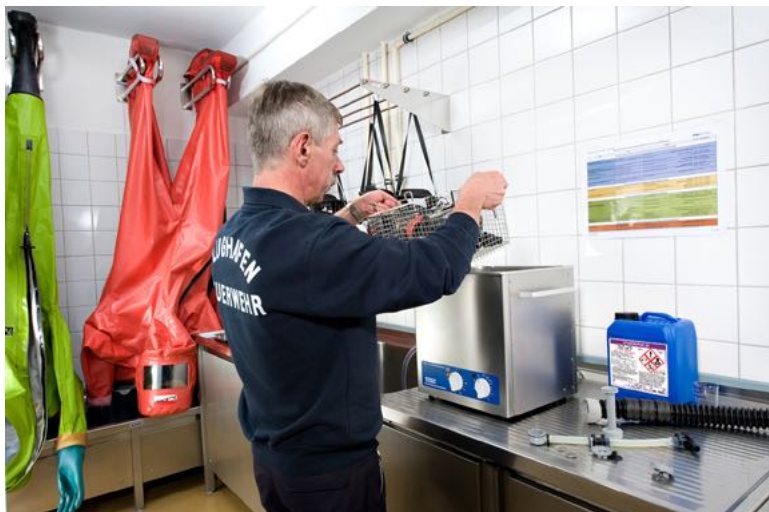
Reinigung von Atemschutzmasken in einer Feuerwehr
