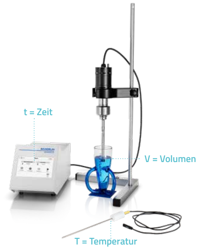
Darstellung des Versuchsaufbaus einer kalorimetrischen Messung zur Leistungsbestimmung
