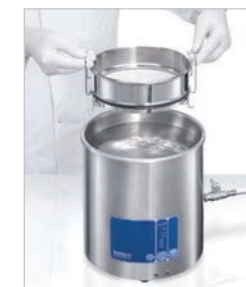
Bains à ultrasons SONOREX pour le nettoyage des tamis d'analyse
