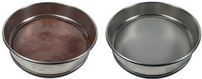
Tamis d'analyse avant et après le nettoyage
