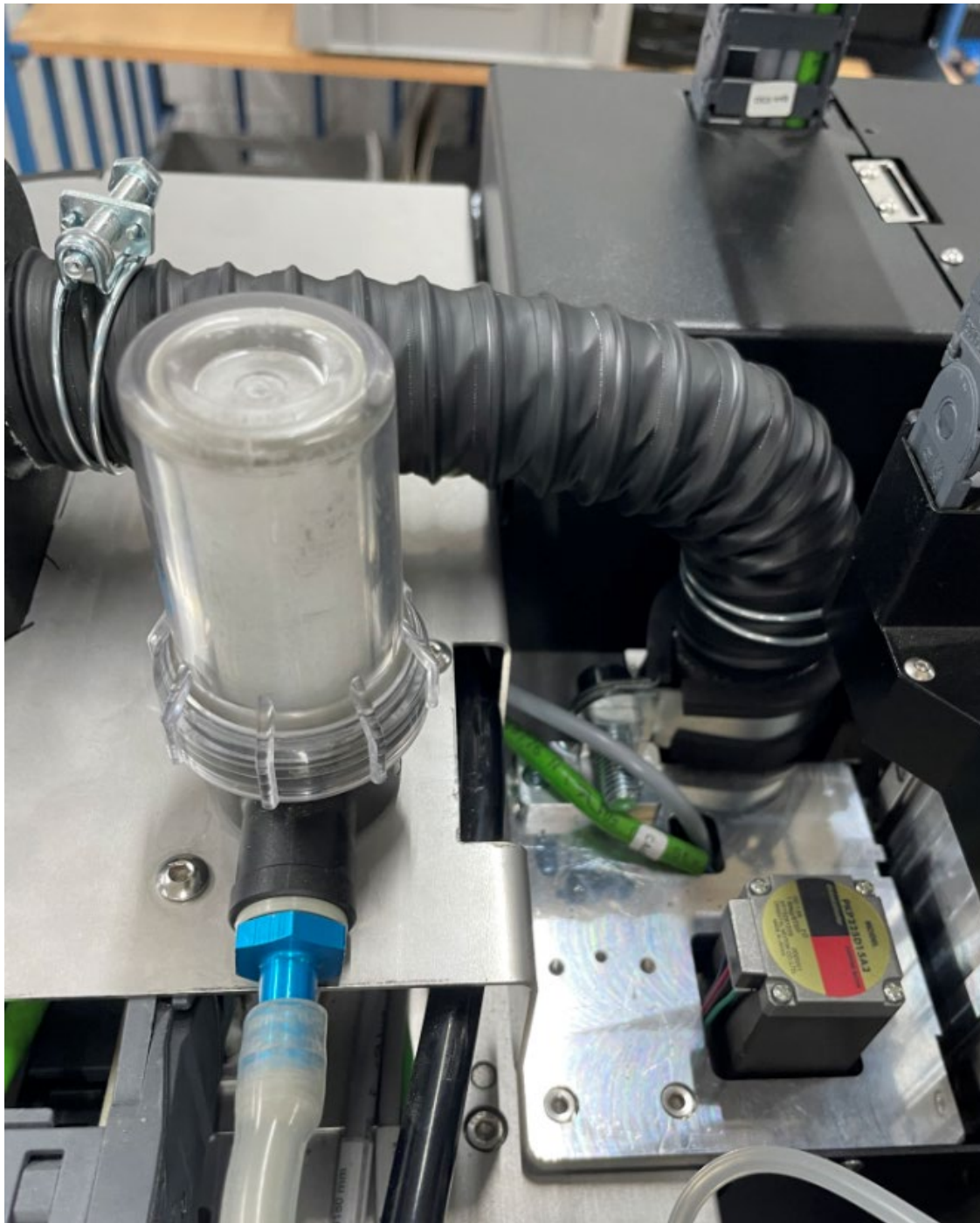
Abbildung 2: montierte Lötrauchabsaugung am XL
