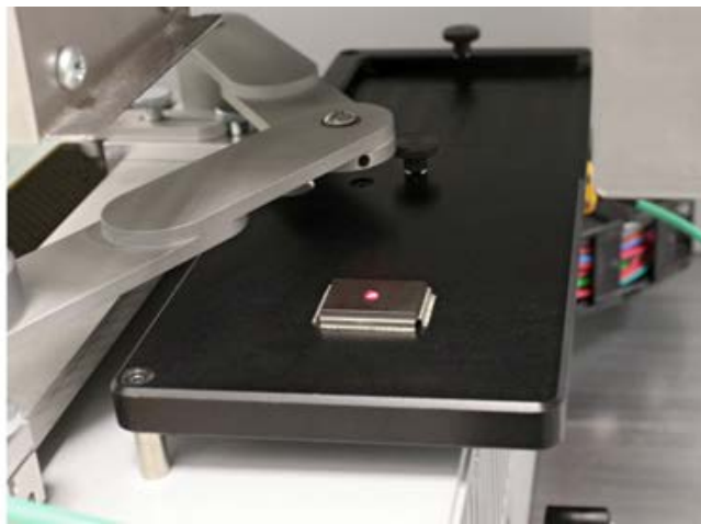
Abb. 23: Die Pipette holt das Bauteil an der mit dem Laser markierten Stelle ab
