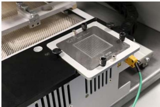
Abb. 24: Die Dip-Schablone auf der Bauteilablage
