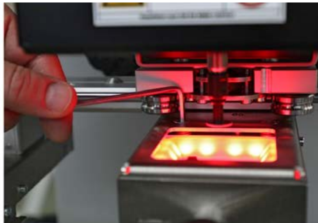
Abb. 13: Zum Korrigieren in X-Richtung einen 3 mm Innensechskantschlüssel einsetzen, dabei das Kamerabild beobachten.
