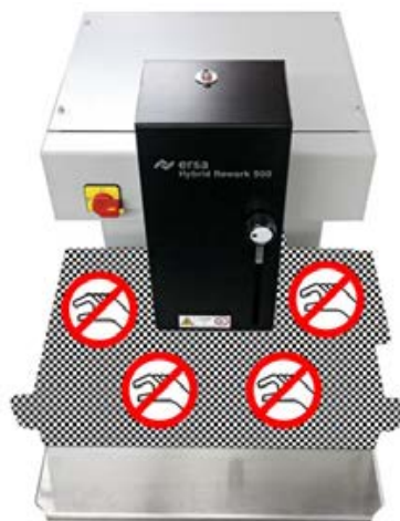
Abb. 2: Reworksystem nicht an der Untenheizung anheben
