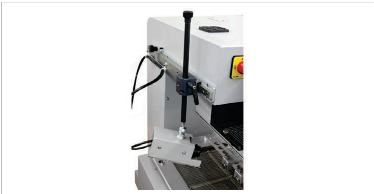
Abb. 8: RPC-Kamera montiert, Beispielabbildung
