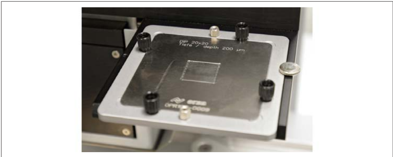
Abb. 40: Mit Flussmittelgel bestrichene Dip-Schablone auf der Bauteilablage
