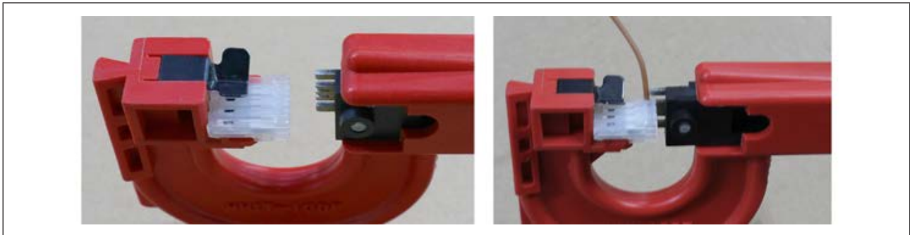
Abb. 20: Beispielabbildung. Links: Einsetzen der Steckverbindung in die Handzange. Rechts: Einführen des Kabels in den Steckerpin von oben und Einpressen des Kabels.
