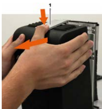
Fig. 49: Déverrouiller la tête chauffante et la retirer.
