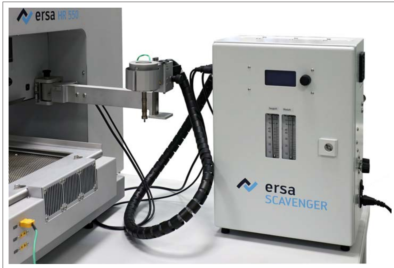
Fig. 39: Disponible en option : Système d'extraction de brasure résiduelle Scavenger
