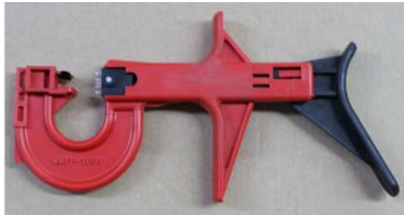
Fig. 14: Pince manuelle pour le sertissage des câbles des connecteurs femelles MAS-CON® avec un pas de 2,54 mm.
