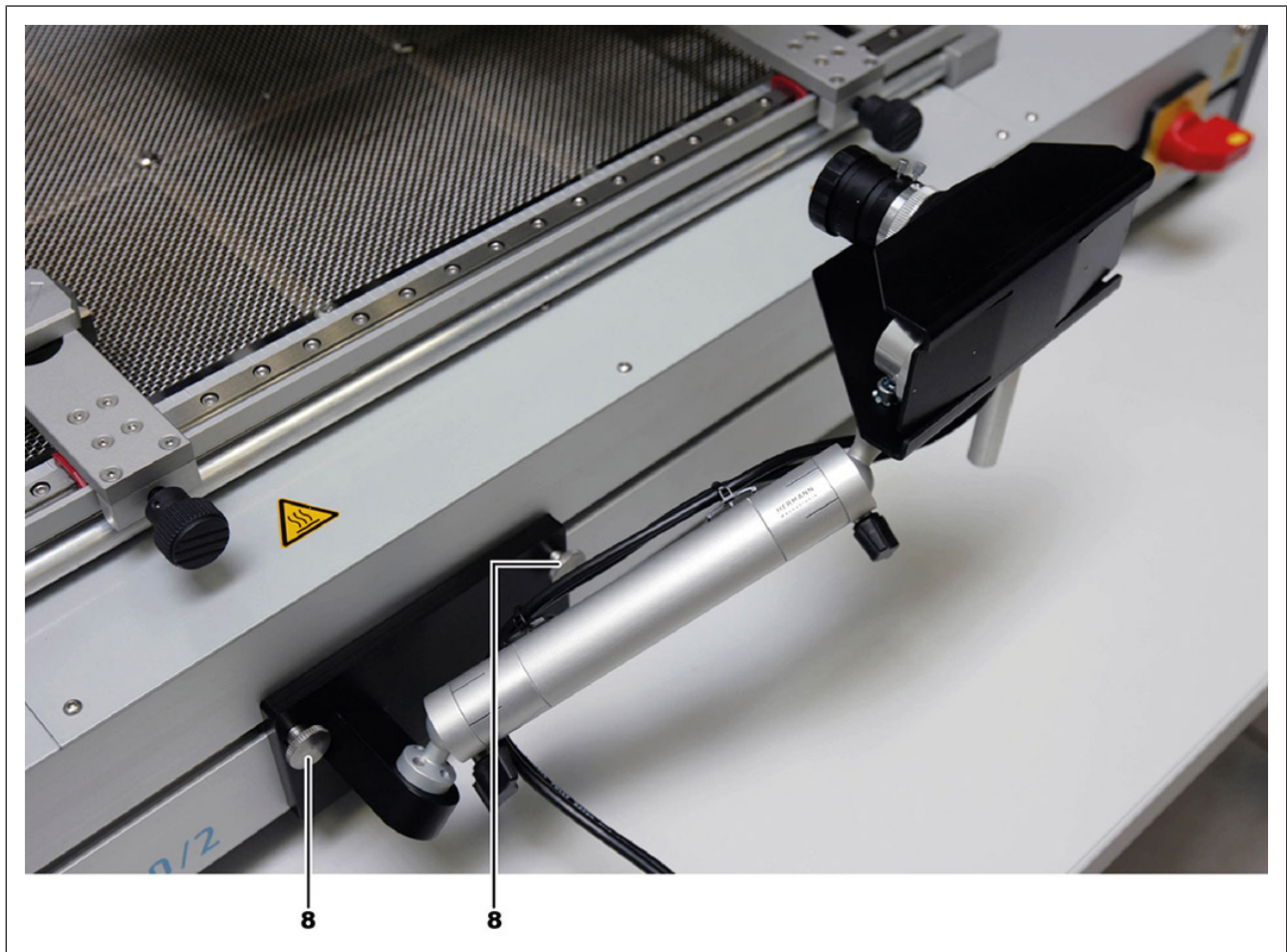
Abb. 10: Montage der RPC-Kamera, Beispielabbildung. Die Kamerakabel unter dem Reworksystem nach hinten führen.
