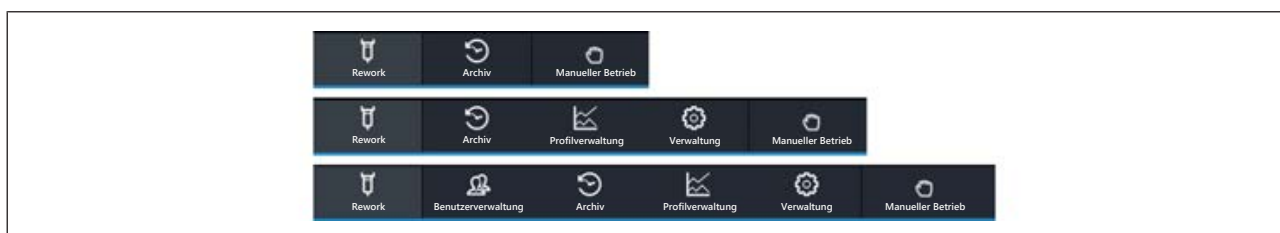
Abb. 37: Menüumfang des Standardbenutzers, des Power-Benutzers und des Administrators (im Tabulator [Rework])
