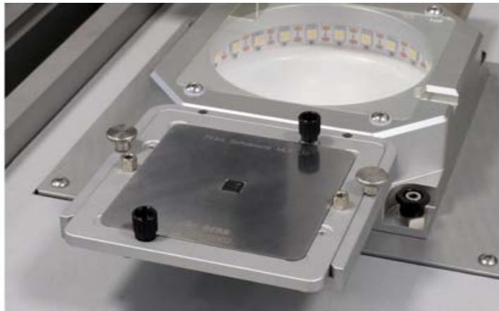
Abb. 48: Beispielabbildung: Das mit Lotpaste bestrichene Bauteil ist in der Print-Schablone eingesetzt und wird in den Schablonenrahmen eingeschoben
