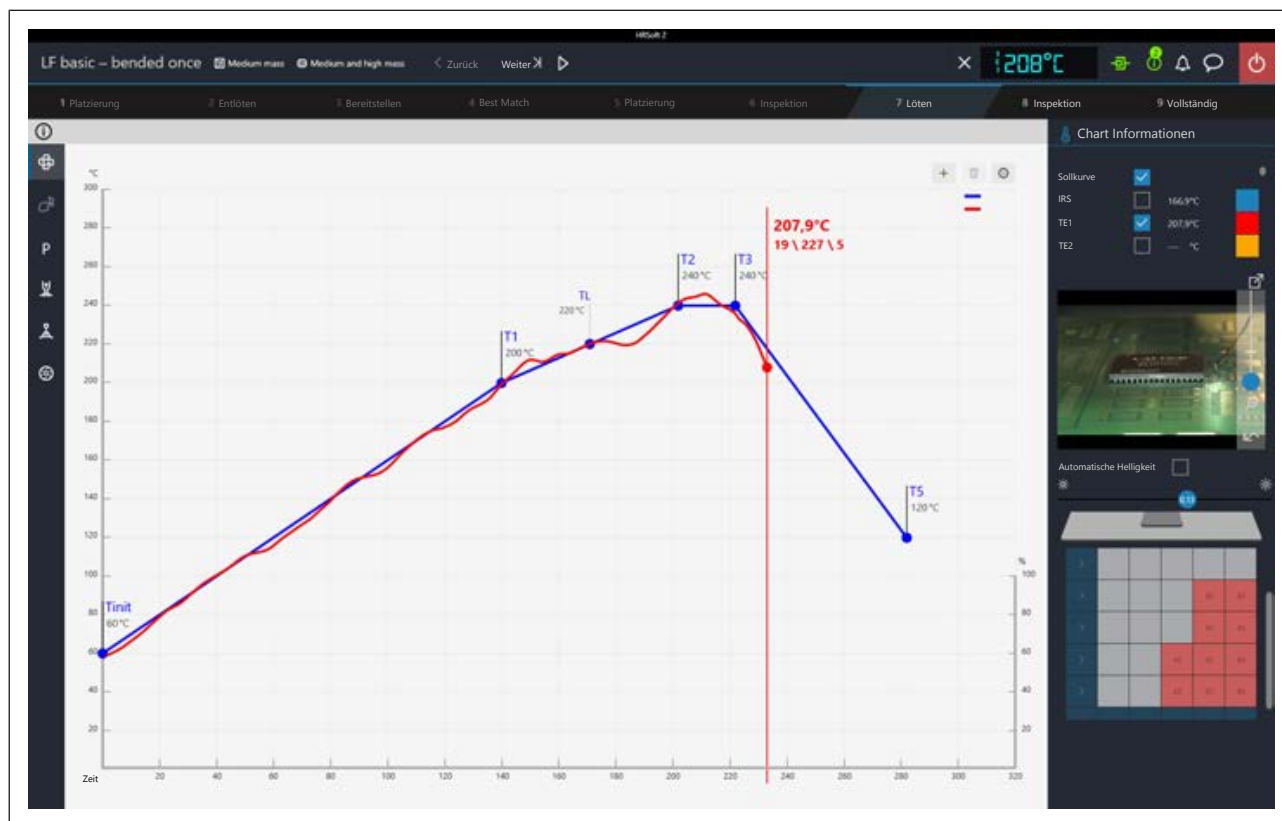
Abb. 52: Der Chart zu nach erfolgtem Einlöten beim Kühlen
