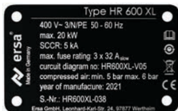
Abb. 53: Beispiel für das Typenschild einer Maschine. Die Angaben sind nicht identisch mit dem Typenschild an Ihrer Maschine.
