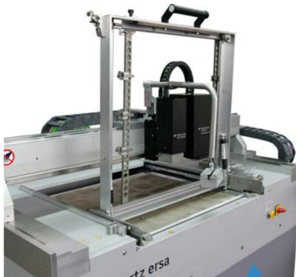
Abb. 16: Leiterplattenrahmen in die Senkrechte geschwenkt
