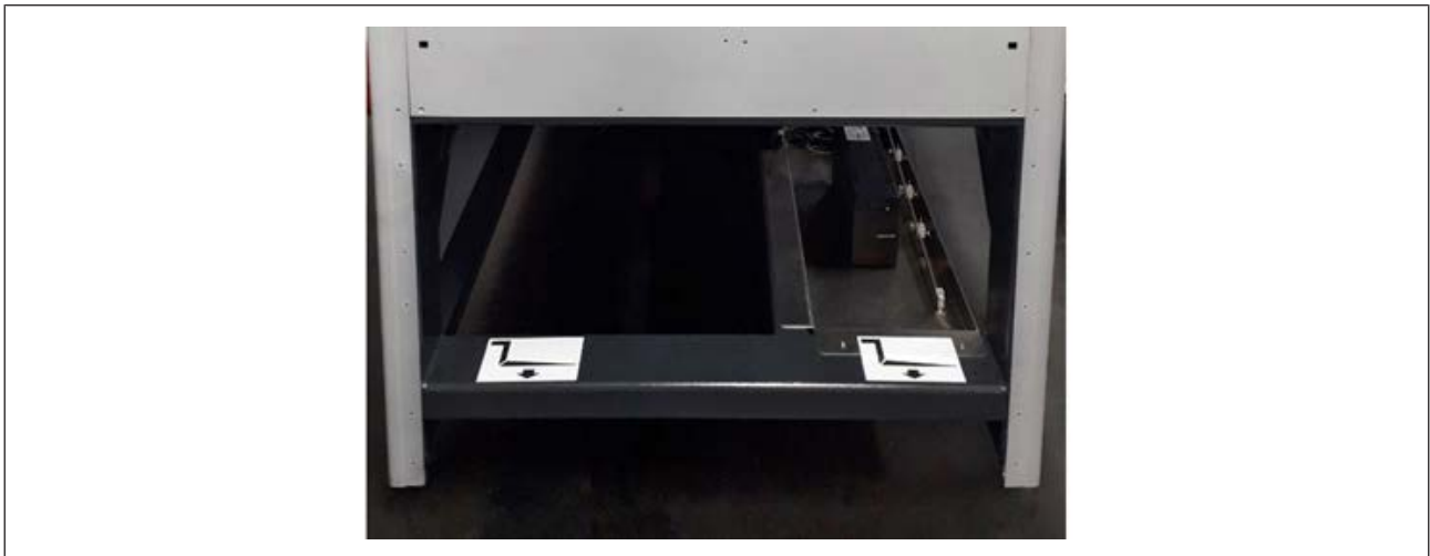
Abb. 6: Anhebungspunkte für den Stapler
