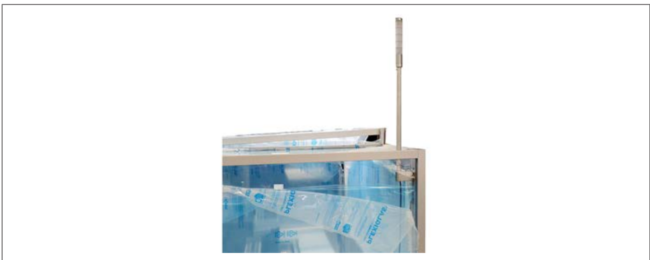
Abb. 18: Meldeleuchte an der Einhausung angebracht
