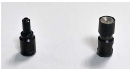
Abb. 63: Beispiel: Heizkopfdüse 5 mm links, Heizkopfdüse 10 mm rechts
