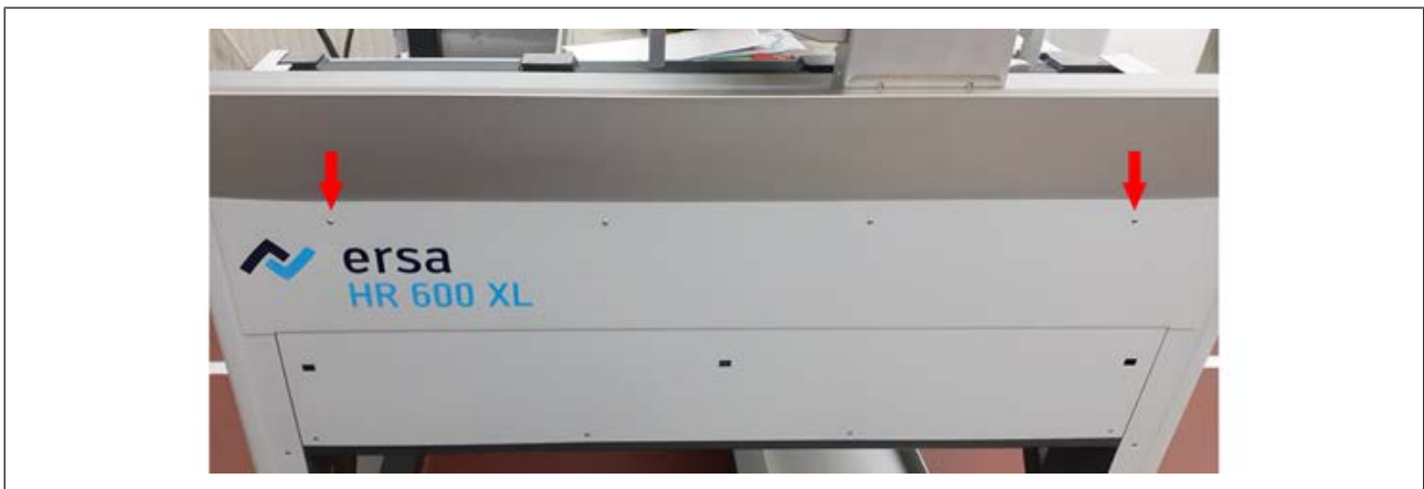
Abb. 19: Lösen der beiden äußeren Schrauben
