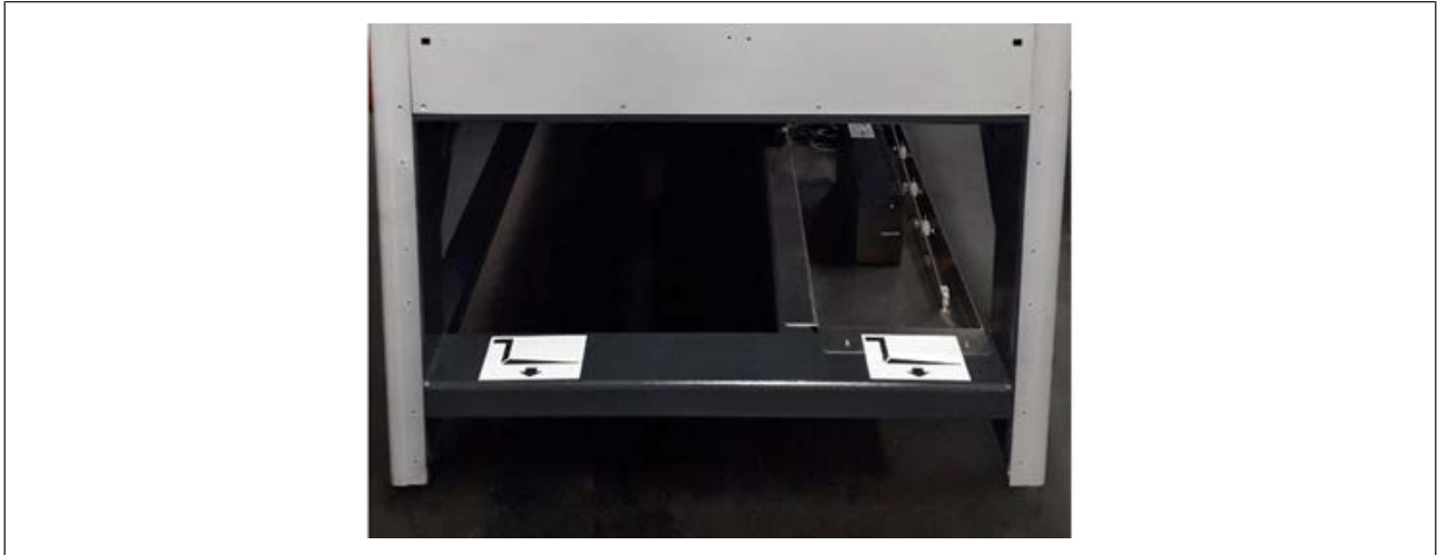
Fig. 6: Points de levage pour le chariot élévateur
