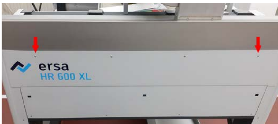
Fig. 19: Desserrer les deux vis extérieures
