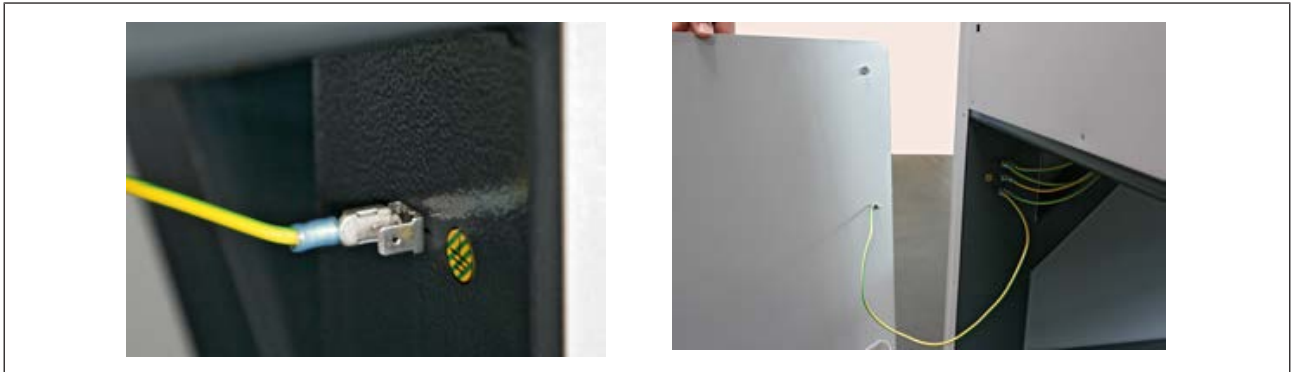
Fig. 12: Brancher le câble de mise à la terre
