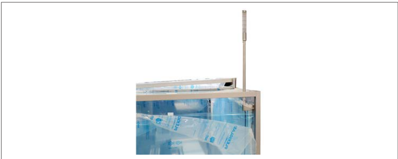
Fig. 18: Voyant lumineux installé sur l'enceinte
