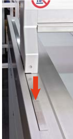
Fig. 54: Huiler la surface de glissement
