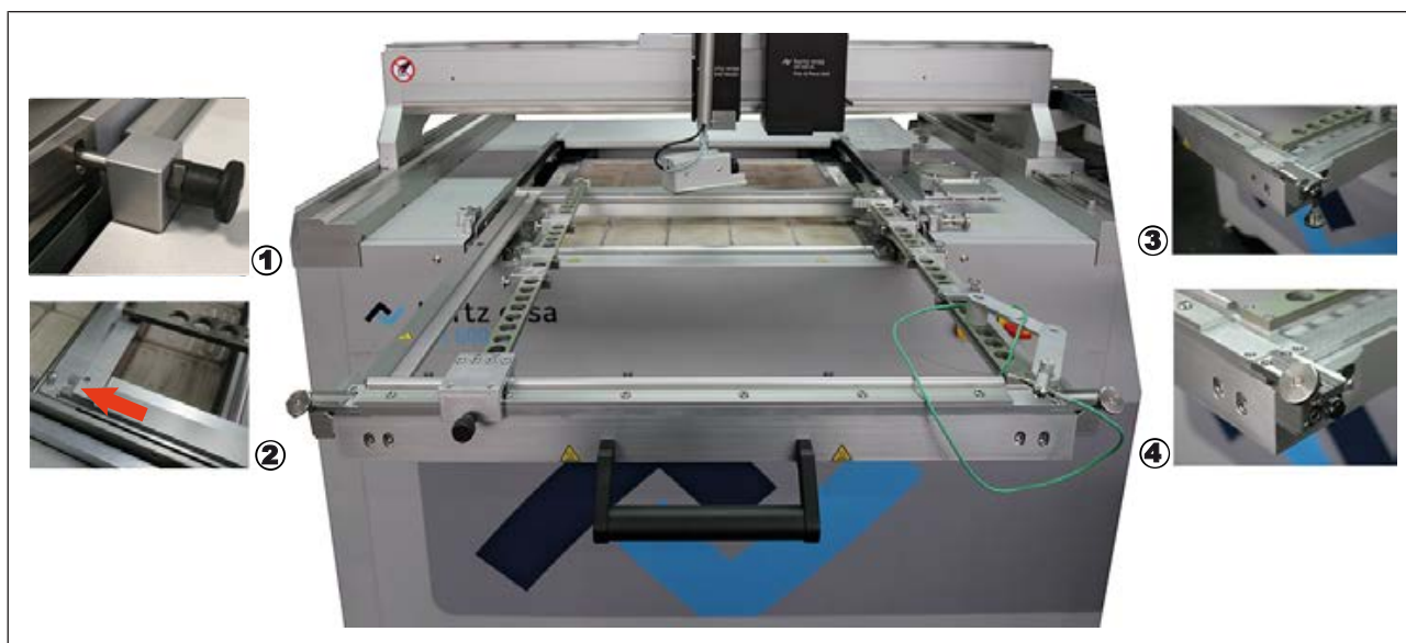
Fig. 15: Insérer le cadre du circuit imprimé
