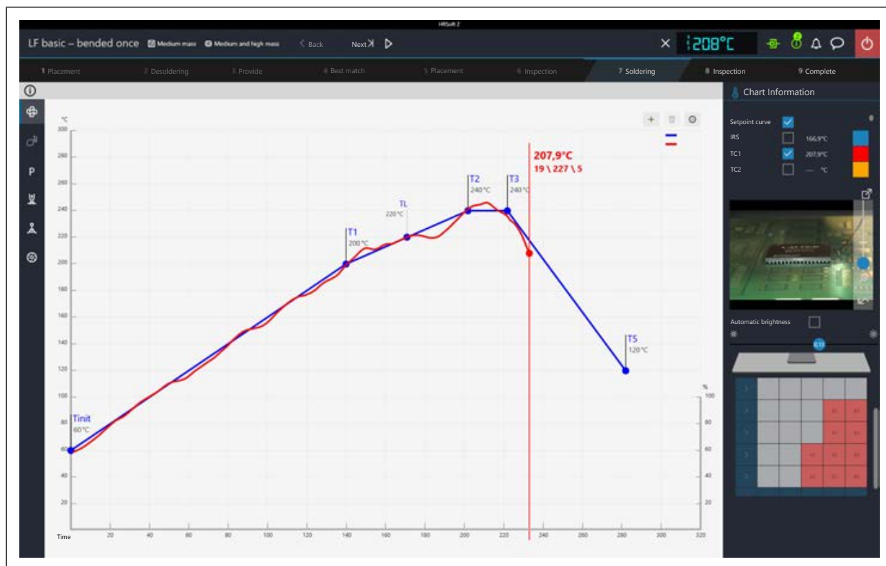
Fig. 52: Le graphique de la brasure après le refroidissement
