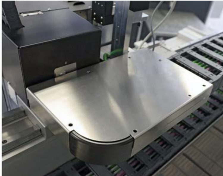
Fig. 22: Dévisser la tôle de protection.
