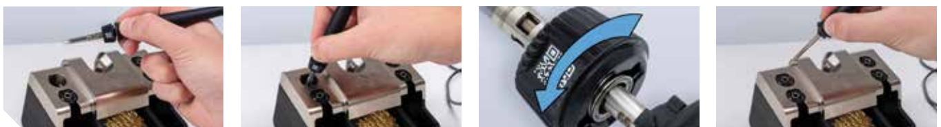
Blitzschneller Spitzenwechsel: von Hand oder mit Hilfe des Ablageständers 0A58, kompatibel mit i-TOOL TRACE und allen LötKolben der i-TOOL MK2 Serie (optional).
