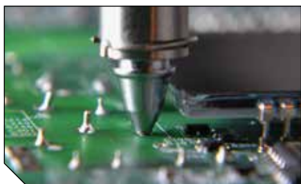
Schmale Entlöspitze für optimale Erreichbarkeit der Lötstelle
