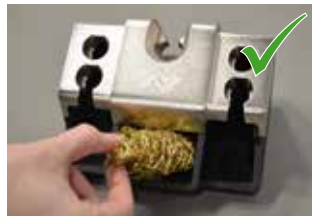
Verschmutzte Metallwolle entfernen, Lotauffangbehälter leeren
