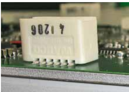
Kunststoff-SMD auf Aluminiumverbundplatine
