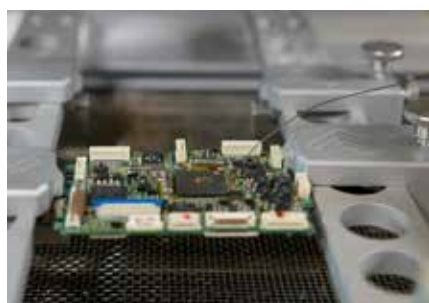
Flexible Haltesysteme passen sich der Größe und Bestückung der Baugruppe an.
