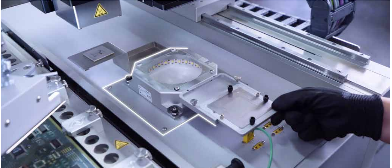
Dip&Print Station an der HR 600 XL – zum definierten Flussmittelauftrag bei BGA
