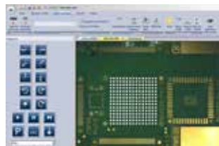
Überlagern von Bauteil und Zielposition
