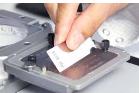
Flusmittelauftrag in Dip-Schablone
