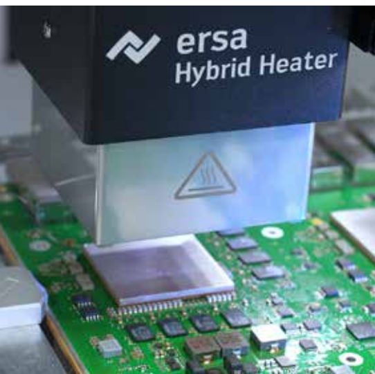
Hybrid-Heizkopf beim Entlöten eines metallischen BGA
