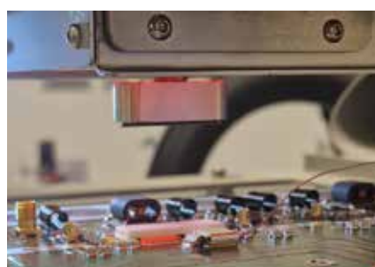
Entlöten eines Leistungshableiters mit einer kundenspezifischen Düse.
