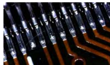
QFP-Lötstellen aufgenommen mit dem Macrozoom-Objektiv des Ersä MOBILE SCOPE
