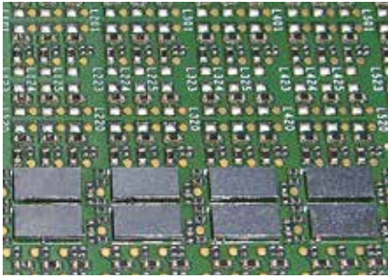
CSP, Micro-BGA 01005-, 0201-, 0402-Chips
