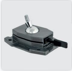
Für alle Werkbänke und Arbeitstische geeignet. Platzmaße 150 x 106 mm. Der Halter kann durch vier Durchgangslöcher (Ø 9 mm) an jeder Tischplatte befestigt werden. Eine Anbohrzeichnung finden Sie auf der Webseite zum Download. Ein kleiner Hebeldruck genügt und um die Kugel stufenlos und in jeder zweckmäßigen Arbeitslage zu fixieren.
