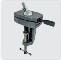
Für Werkbänke oder Arbeitstischplatten mit einer maximalen Tischplattenstärke von 80 mm. Der Halter ist auf Grund seiner Tischklemmung schnell und leicht an jeder Werkbank oder Tischplatte anzubringen. Ein kleiner Hebeldruck genügt und um die Kugel stufenlos und in jeder zweckmäßigen Arbeitslage zu fixieren.
