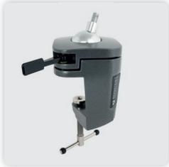
Für Werkbänke oder Arbeitstischplatten mit einer maximalen Tischplattenstärke von 80 mm. Der Halter ist auf Grund seiner Tischklemmung schnell und leicht an jeder Werkbank oder Tischplatte anzubringen. Ein kleiner Hebeldruck genügt und um die Kugel stufenlos und in jeder zweckmäßigen Arbeitslage zu fixieren.
