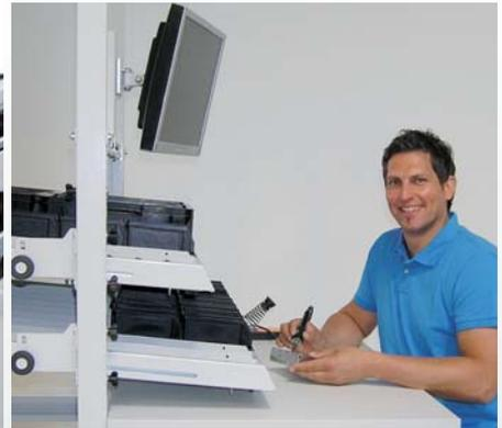
**Die Regale sind für das FIFO-Prinzip konzipiert – was zuerst zugeführt wird, wird auch zuerst entnommen. Über geneigte Ablagen, optional ergänzt mit Trennstegen und Röllchenleisten, bewegen sich Behälter selbstständig von der Beschickungsseite zur Entnahmeposition.**
