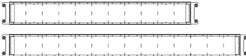
für Tischbreite 1230 mm (nutzbare Breite für Einsatzplatten: 1100 mm)
