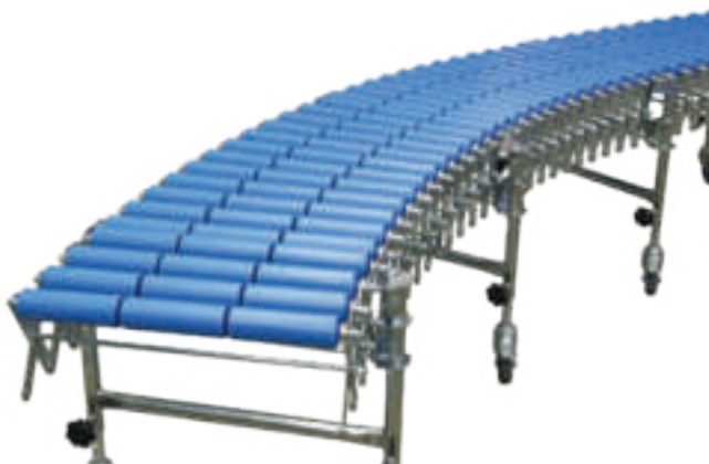
Rail à ciseaux avec galets de support en tube de plastique bleu
