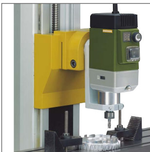
MICROMOT-Adapter in Verbindung mit den Feinfräsen FF 500/BL und FF 500/BL-CNC (Seite 70).
