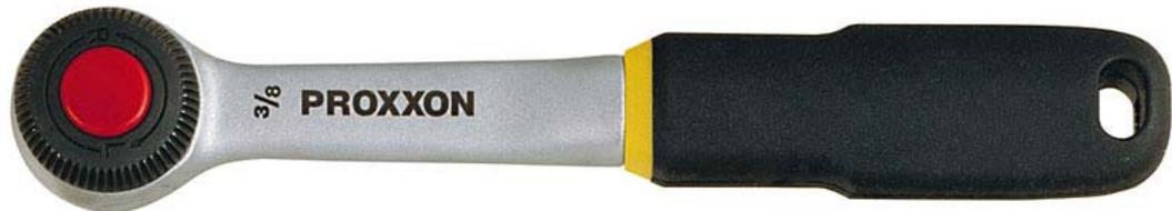
Mit Umschaltfunktion direkt auf dem Ratschenmechanismus. Mehrere der 52 Zähne rasten gleichzeitig ein und übertragen extrem hohe Drehmomente. Entriegelungs-Mechanismus: Lösen der Einsätze durch Knopfdruck. Kopf und Schaft aus einem Stück CrV-Stahl geschmiedet, 2x vernickelt und matt-verchromt. Griff aus öl- und säurefestem TPR (Thermoplastic Rubber) mit praktischer Bohrung zum Aufhängen.
