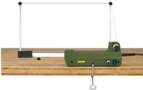
Auflagefläche mit Bohrung für Schraubzwinde ermöglicht stationären Einsatz. Praktisch auch zum Trennen handelsüblicher Styroporplatten (100 x 50 cm).
